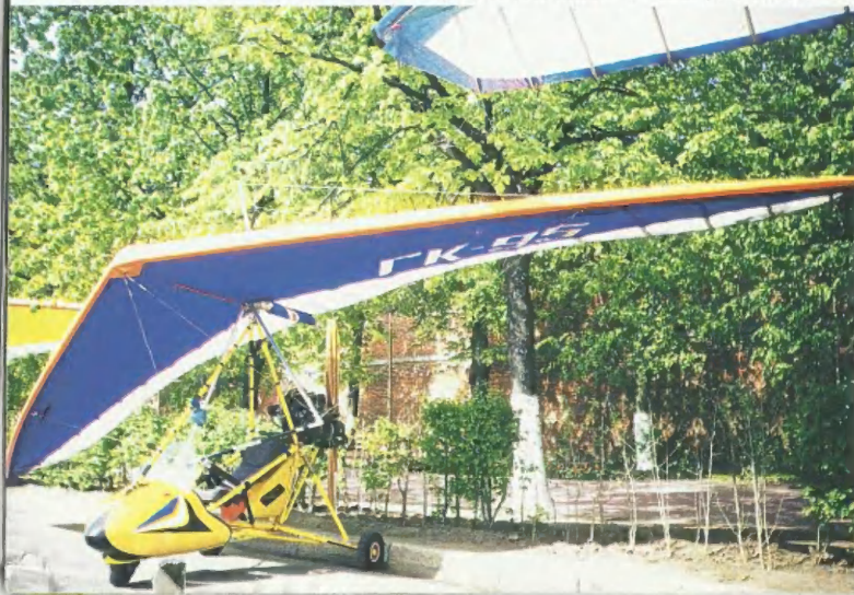
Е-12 «Стручок» - мини-самолет из г. Ульяновска. Новая разработка СТК «Взлет» с убирающимся шасси (г. Нижний Новгород).
